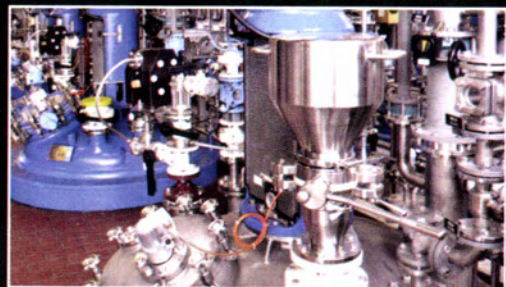
反応槽への原料投入に使用している例
