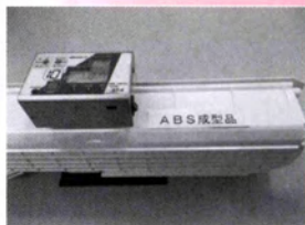
BN-77, 4.0%複合 ABS事務機部品 表面: 10^{11} \sim 10^{12} \Omega/\square
